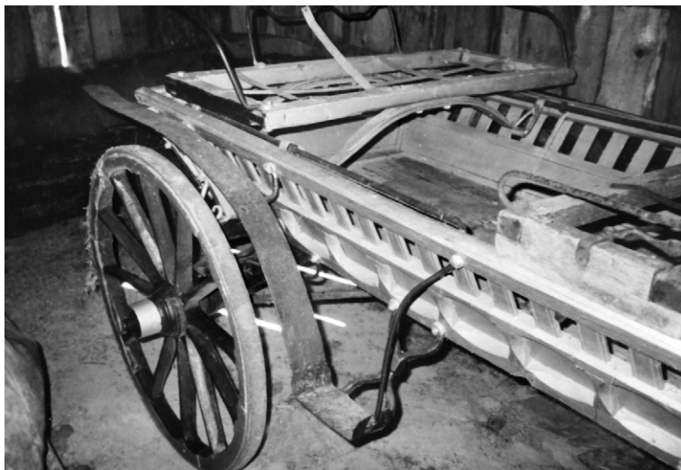
9 pav. Brikelio lipynė ir sparneliai – purvasaugiai. 1936 m. Šilalės r., Paragaudžio k. 2001 m. J. Morkūnienės nuotraukos
