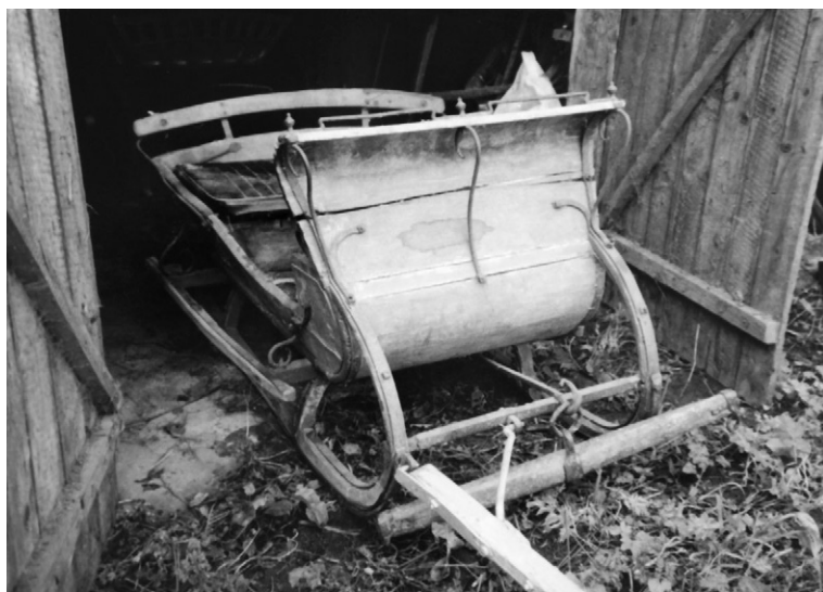
14 pav. Vienkinkių šlajukų priekinės dalis apkaustai ir ienos-dišliuko įtaisys. Šilalės r., Paragaudžio k.
