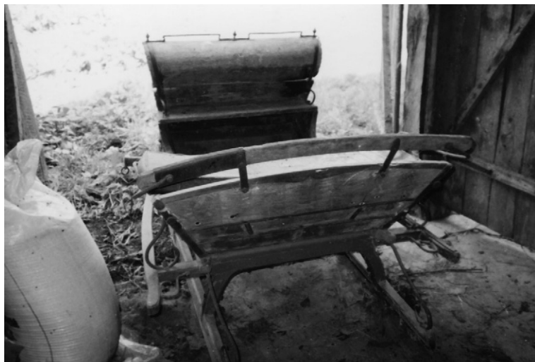
15 pav. Vienkinkių šlajukų užpakalinės dalis apkaustai. Šilalės r., Paragaudžio k. 2001 m. J. Morkūnienės nuotraukos
